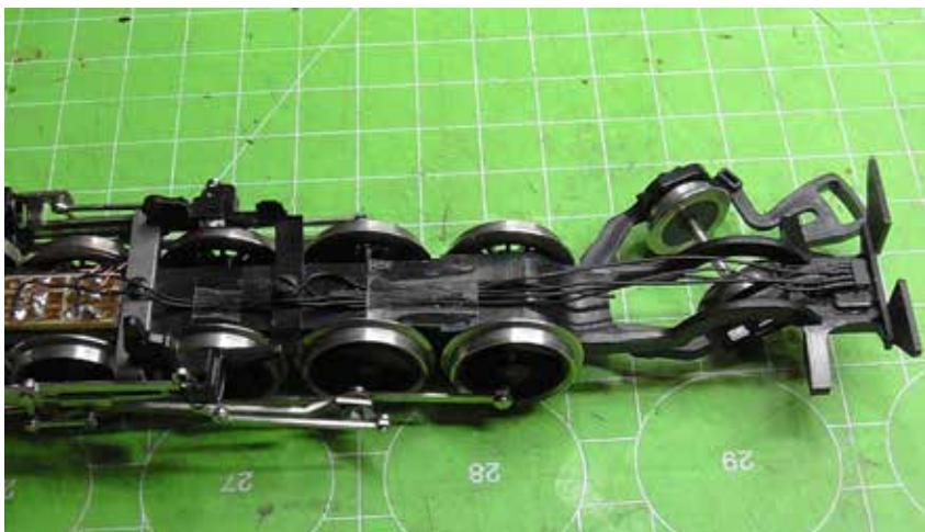
Die vier Kabel können problemlos bis zur vorderen Platine geführt werden, wo die Verbindungen zur Beleuchtung und zum Fahrstrom geschaffen werden.
