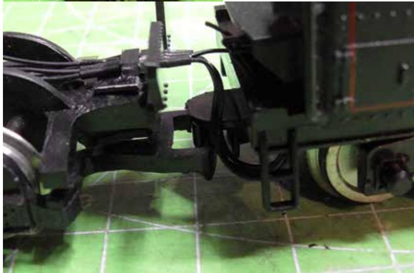
Die elektrische Kopplung von Tender und Lokomotive erfolgt durch ein vierpoliges Mikrokabel, dessen Buchse am Ende der Lok eingeklebt wird. Über die Kabel laufen Pluspol (blau), Licht vorn (weiß) sowie der Fahrstrom rechts und links von der ersten gekuppelten Achse. Für die Durchführung der Kabel muss eine Nut in das Tendergewicht gefräst werden. Die Mikrokabel sollte man nicht zu oft zusammenfügen und trennen und vor allem vorsichtig!
