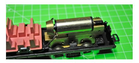
Der Motor von SB Modellbau ein Schmuckstück im Aussehen und Laufverhalten.
