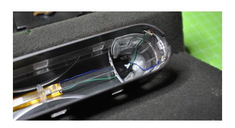
Die winzigen roten Rückleuchten (SMD LED) sind mit Sekunden-kleber fixiert und mit isoliertem Kupferdraht verkabelt. Sie leuchten gemeinsam mit der Innenbeleuchtung und sind abschaltbar. Zur Verhinderung von Streulicht innerhalb des Gehäuses werden sie rundum mit z.B. Pearl Maker schwarz abgedeckt. Die Paste wird hart und hält die LEDs.
