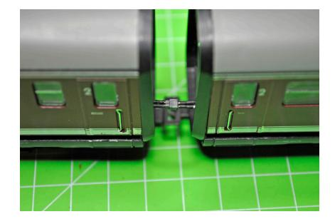
Isolierte Mikrostecker von LedBaron schaffen die Verbindung zwischen den drei Wagen für die Innenbeleuchtung und die Rücklichter.
