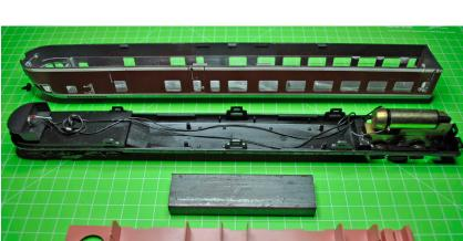
Das Bleigewicht ist nur eingeklemmt und wurde mit doppelseitigem Klebeband befestigt. Stromabnahme für den ganzen
