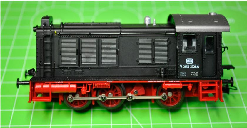
Das Führerhaus wird leicht nach hinten gekippt und abgezogen, die Motorhaube ist eingeklipst und kann nach vorsichtigem Weiten abgezogen werden. Achtung: Frontlampen und Ölpumpe vorher in Sicherheit bringen, sie springen leicht ab.
