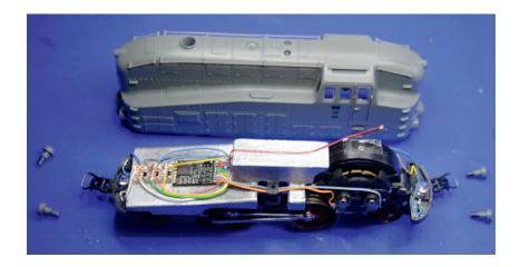
Das Gehäuse der Lokomotive 1 wird nur durch Einstecken der vier Puffer gehalten.
