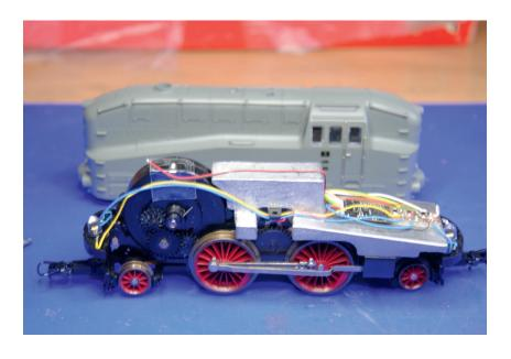
Die warmweißen 3-mm-LEDs passen in die alten Kunststofffassungen und sind daher einfach zu installieren. Die winzige LED für den Führerstand ist bereits mit einem steifen Draht verkabelt und kann so ohne weitere Befestiogung unter den Kabinenhimmel geführt werden.
