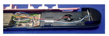
Hier die verdrahteten Platinen mit Anschluss an den Fahrstrom und die Frontbeleuchtung.
