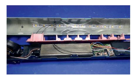
Anschluss der Innenbeleuchtung mit ausreichend langen Kabeln, um das Gehäuse abklappen zu können. Alternativ kann die Verbindung auch mit einem Mikrostecker hergestellt werden, wobei das Gehäuse dann komplett abgenommen werden könnte.
