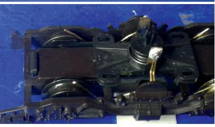
In der Mitte des Drehgestells sitzt eine Feder, die die Stromabnahmebleche auf die innen in die Räder eingelassenen Rillen drücken soll, was aber nach 50 Jahren nicht mehr so gut funktioniert. Die beiden zusätzlichen Stromabnehmer werden an die Messinglaschen gelötet.
