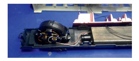
Zwischen den beiden Motoranschlüssen wurde der Entstörkondensator entfernt und die Anschlüsse vom Decoder angelötet.
