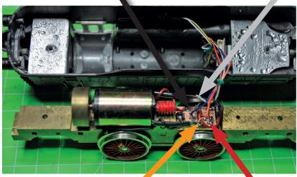
Die Streifenplatine hilft auch hier, die Kabel übersichtlich an die Verbraucher zu verteilen.
