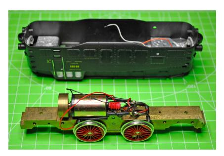
Die Verbindungen zwischen den Radschleifern und dem Motor werden entfernt.
