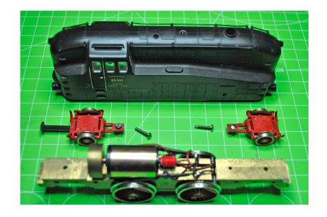
Das Lokgehäuse wird von zwei Schrauben gehalten, die nach Entfernung des Vor- und Nachläufers sichtbar werden.
